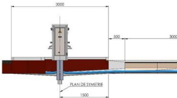
Plan d'installation d'une borne de service avec 2 regards de vidanges
