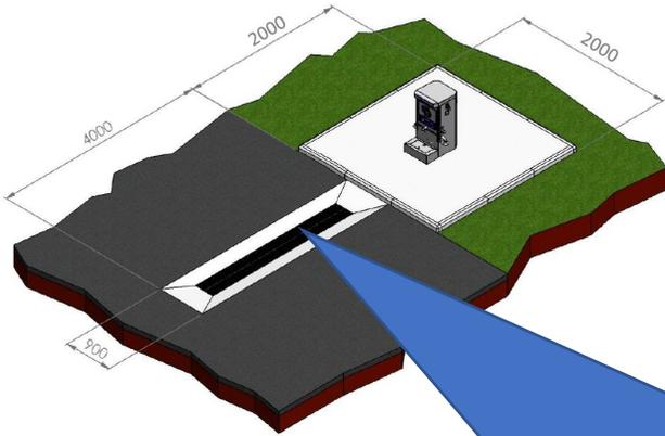
Fixation en béton 50 cm maxi
